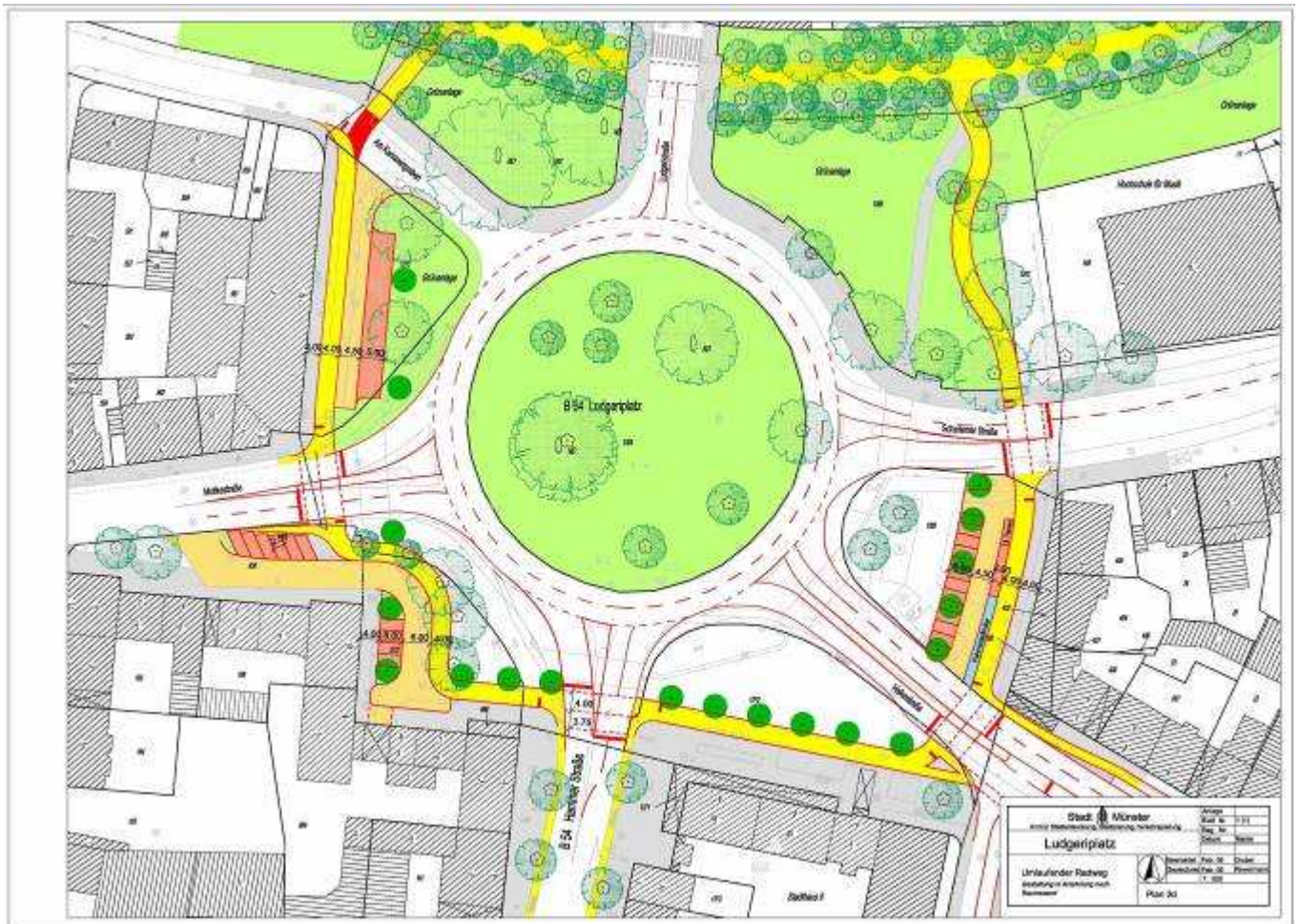
Deutlich abgesetzter Fuß-/ Radweg mit Teilsignalisierung
