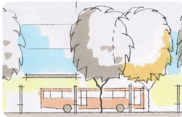
Inszenierung der vorderen und hinteren Baumreihen durch Zu- und Wegschalten der Akzentuierung sowie ggf. Differenzierung der eingesetzten Lichtfarben.
