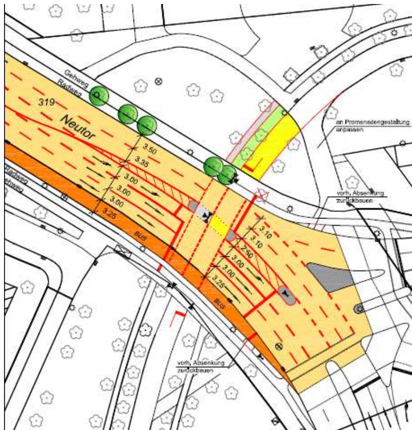
Bild 10: Planung einer sicheren neuen lichtsignalgeregelten Querungsstelle am „Neutor“ für Fußgänger und Radfahrer
