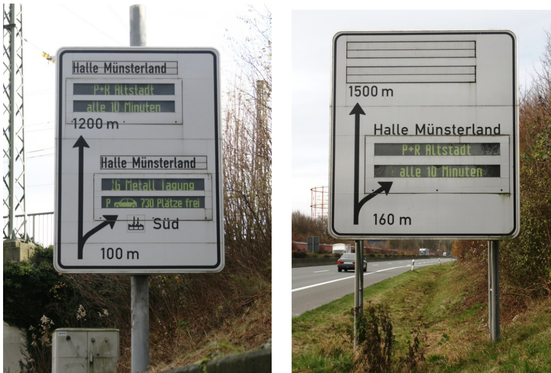
Abb. Bestehende Wechselwegweiser auf der B51 mit einer Zielführung über Veranstaltungsnamen
