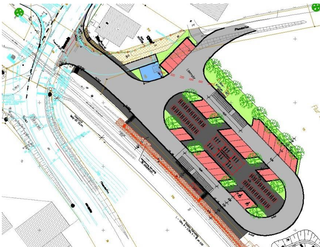
Abbildung 62 Vorentwurf Buswende Haltepunkt Roxel
