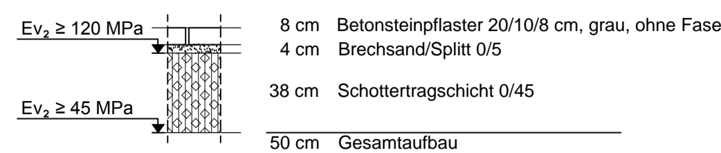
Aufpflasterung / Wohnstraße geplanter Deckenaufbau
