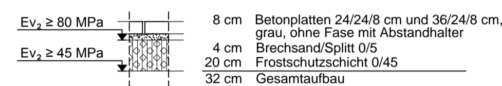
Gehweg geplanter Deckenaufbau
