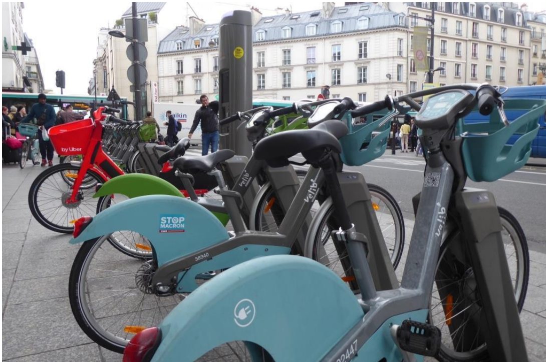
Abb. 33: Velib' in Paris in neuer Form nach Betreiberwechsel im Jahr 2018: 1/3 der Räder in Türkis als Pedelec, 2/3 in Grün als herkömmliches Mietrad – beide an derselben (neu konzipierten) Station
