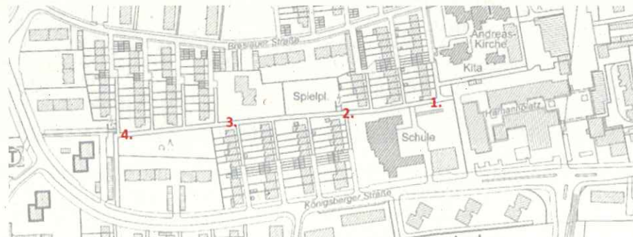
Abbildung 1: Angeordnete Maßnahmen auf dem Verbindungsweg zwischen Königsberger Str. und Hamannplatz; 1. u. 4.: VZ 239 + ZZ 1022-10; 2. u. 3.: Entfernung der Umlaufsperrn
