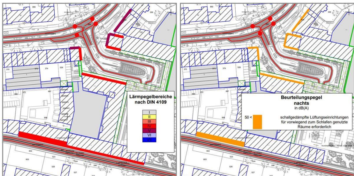
Abbildung 1 | Gebäudelärmkarten Verkehrslärm (Maximalsituation). Links: Darstellung der Lärmpegelbereiche (LPB) gemäß DIN 4109 (Angabe des höchsten LPB je Fassade). Rechts: Darstellung der Bereiche für zusätzliche textliche Festsetzungen zur Lärmvorsorge (schallgedämpfte Lüftungseinrichtungen für vorwiegend zum Schlafen genutzte Räume) (ZECH Ingenieurgesellschaft mbH Lingen, 08.01.2021 S. 53 und 55; Anlage 4.1 und 4.3 (verändert)).
