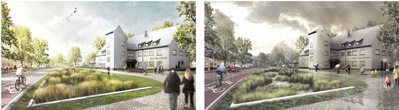
ABBILDUNG 7: ZENTRALE MULDE ALS TEIL DES REGENWASSERBEWIRTSCHAFTUNGSKONZEPTS FÜR DAS NEUE WOHNQUARTIER AUF DEM GELÄNDE DER EHEMALIGEN OXFORDKASERNE (SITUATION OHNE REGEN LINKS, MIT REGEN RECHTS)
