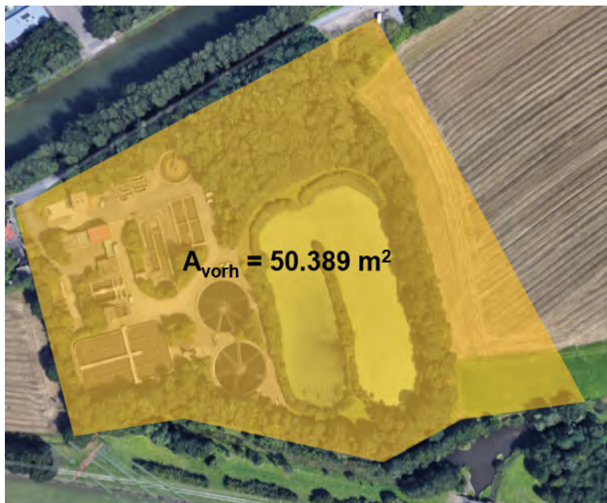
ABBILDUNG 45: MAXIMAL MÖGLICHE ANLAGENAUSDEHNUNG FÜR EINE KLÄRANLAGE SÜD
