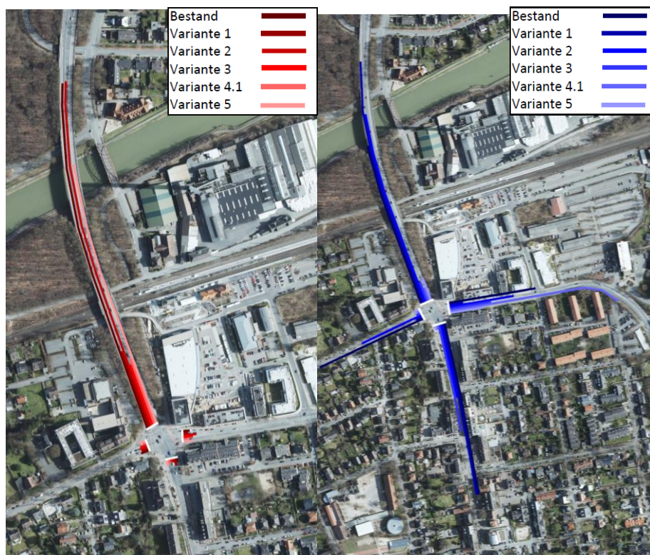
Abbildung 11: Mittlere Staulängen (nach [1])
