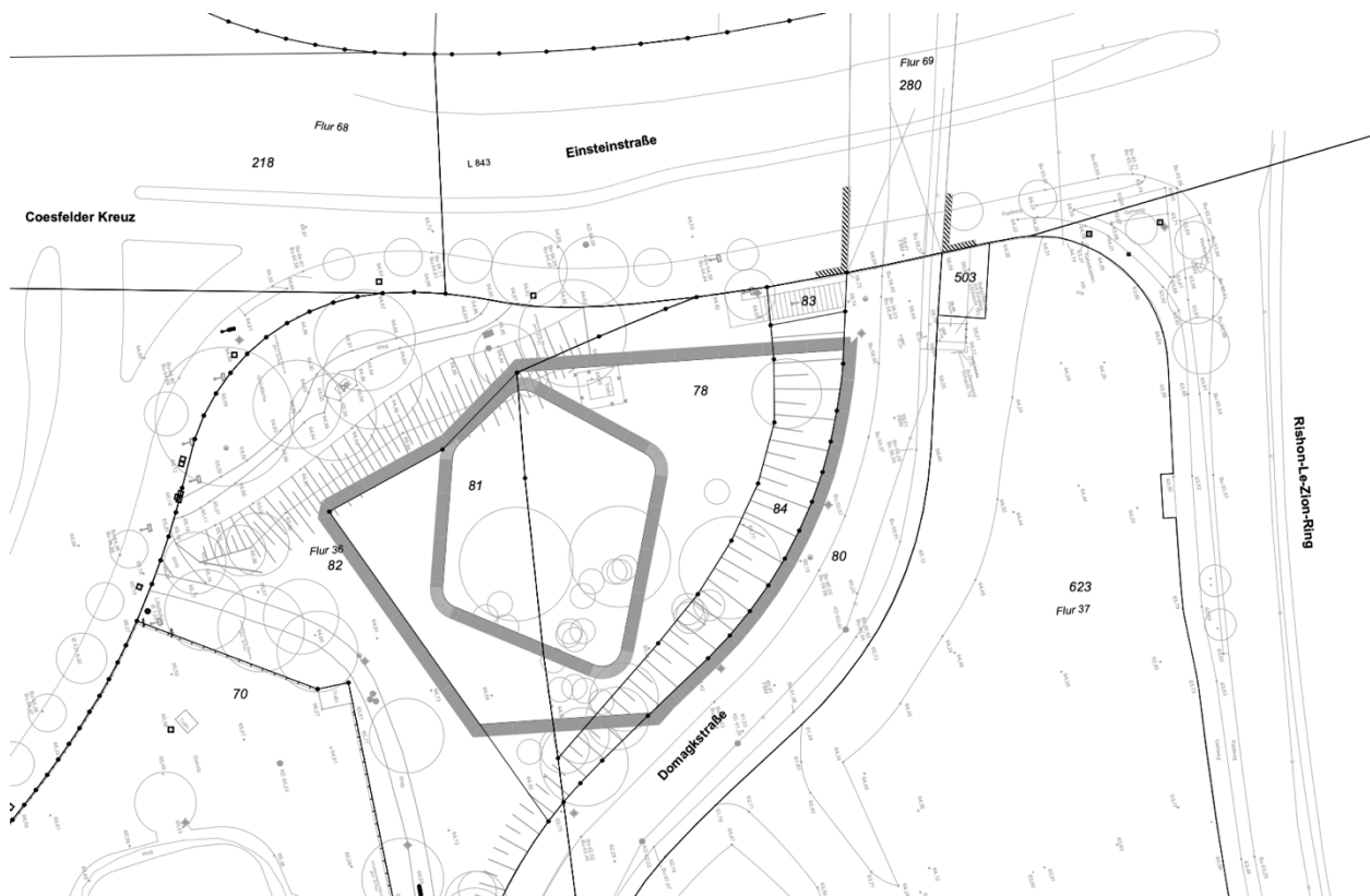
Abbildung 2: Räumlicher Geltungsbereich des Vorhaben- und Erschließungsplans differenziert in ober- und unterhalb der Geländeoberfläche (unterhalb = größere Abgrenzung)
