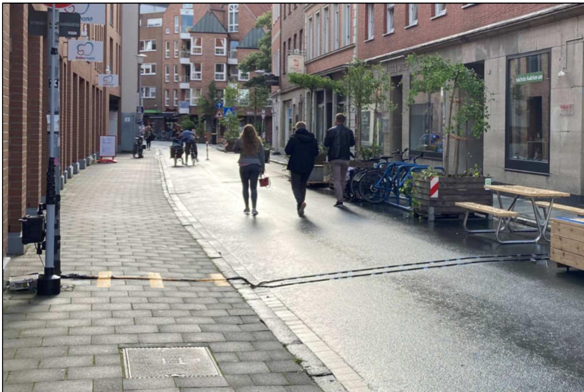
Abb. 42: Erfassung des Radverkehrsaufkommens mittels Druckschlauchsystem (Hollmann 2021, S. 25)
