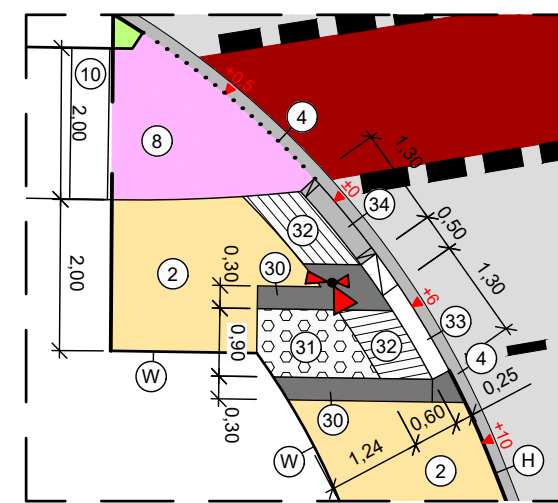
Detail Planung - südwestliche Querung Maßstab 1:100
