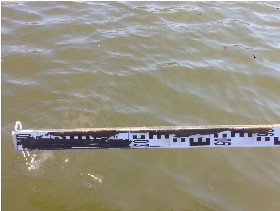
Abbildung 4: Die Messlatte zur Erhebung der Referenzwerte. Zu sehen sind Reste des Schlamms.
