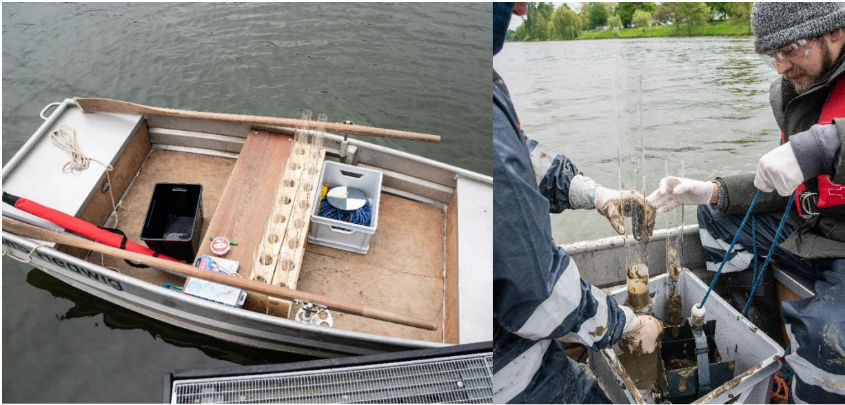
Abbildung 5: Durchführung der Sedimentprobenahme. Links: Ein Teil der Ausstattung auf dem Arbeitsboot "Hedwig", rechts: Entnahme der Sedimentproben mit Hilfe eines Eckmann-Greifers
