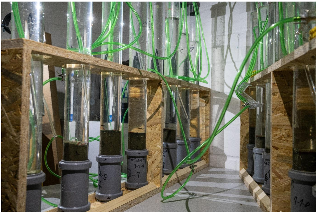
Abbildung 8: Die Sedimentproberöhren mit den Schläuchen zur Belüftung bzw. Eingasung von Stickstoff
