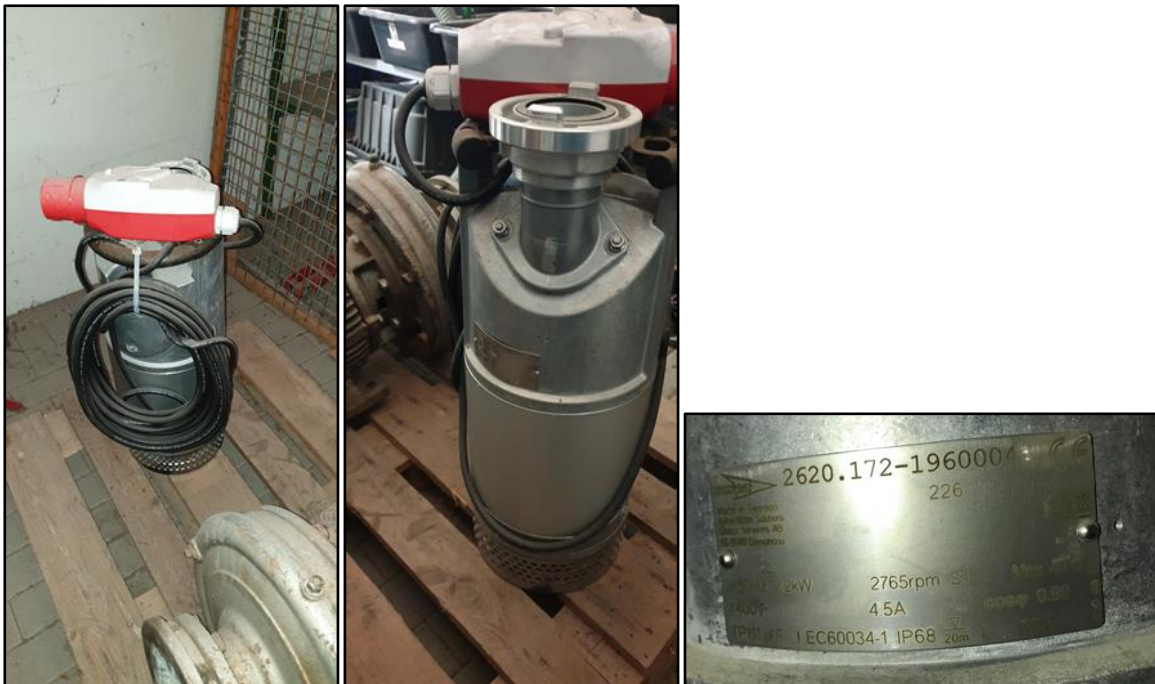
Abb. 42 + 43 +44 Umwälzpumpe eingelagert im Betriebshof_ Flygt 2620.172-1960004 (2,2kW ; 4,5 A)
