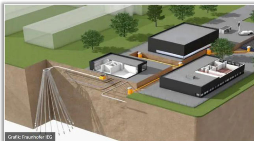
Abbildung 111: Prinzipdarstellung Geostar-Erdsonden (Fraunhofer IEG)
